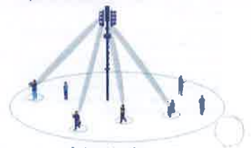
Antenne active 5G avec système d'émission et réception directionnel des signaux fréquences > 10GHz
